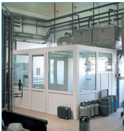
Hygienische Reinraum-Abfüllstation für Lebensmittelharz
